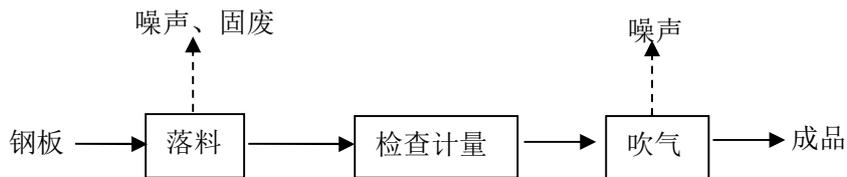
图 2.3-2 密封圈生产工艺及产污环节图
